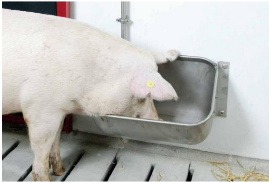
Auge inox pour cochon fixation murale Dimensions 50 longueur, 30 largeur, prof = 20 cm Hauteur de fixation pour porc adulte : 30 cm coté bas
